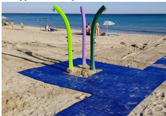
La singola doccia solare, realizzata in polietilene ad alta densità, è dotata di un apposito serbatoio per l'acqua in grado di riscaldare il liquido autonomamente perchè il materiale di cui è composto permette ai raggi solari di penetrare all'interno e ne sfrutta la capacità di produrre calore.
